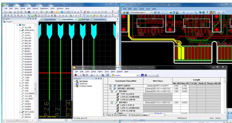
在原理图或 Layout 中，使用基于电子表格的编辑器设置设计约束。
