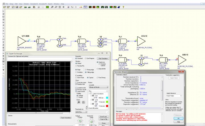
确定布线约束，并借助 PADS Standard Plus 信号完整性分析以及 HyperLynx® 技术提供的支持来验证完成布线的 PCB。
