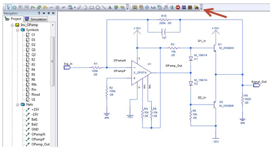
PADS Standard Plus 原理图包含集成的模拟仿真环境，因而能够轻松地驱动仿真和 PCB Layout，并缩短整体设计时间。
